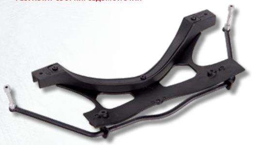
Так выглядят собранные защита картера и стабилизатор поперечной устойчивости, соединенные с передней поперечиной
